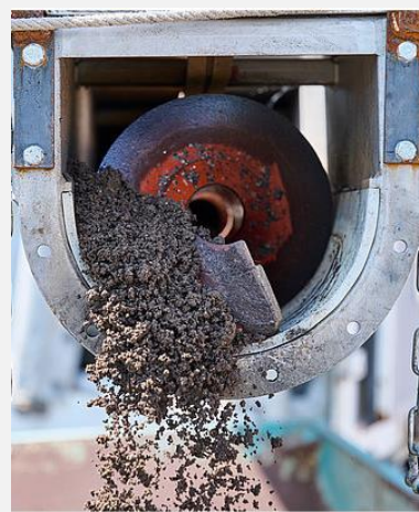
Entwässerter Schlamm für Transport
